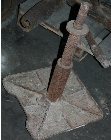
Fot.35 Płyta oporowa podstawy
