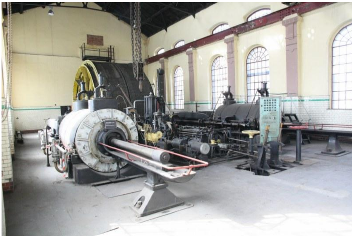
FOT.3 Stan obecny, brak pomostu i poręczy
